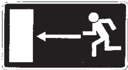
Richtungsangabe links für Rettungsweg
