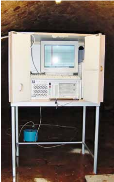
Seismische Messstation im Keller eines Gebäudes
