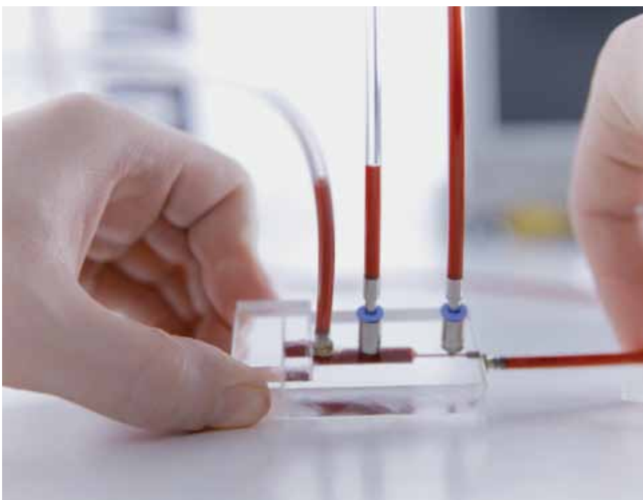
Damit Chirurgen an »blutenden« Simulationsmodellen üben können: Überprüfen der Anschlüsse für ein künstliches Kreislaufsystem
