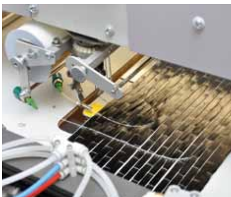
Fertiges Sensorgelege mit aufgestickter optischer Faser
