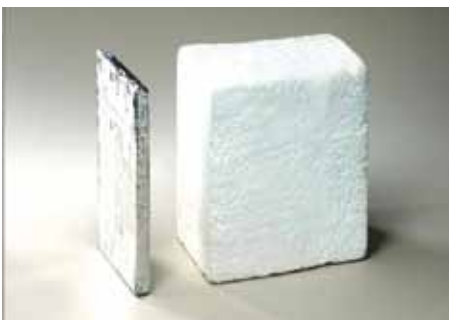
Der Vorteil der Platzeinsparung wird im Vergleich von Polystyrol und VIP ganz deutlich.
